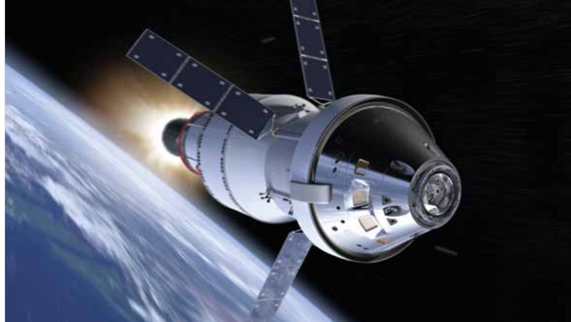
La navetta della Nasa Orion pensata per il sistema di lancio SLS per lo spazio profondo. Il modulo di servizio è fornito da ESA e realizzato in Italia
