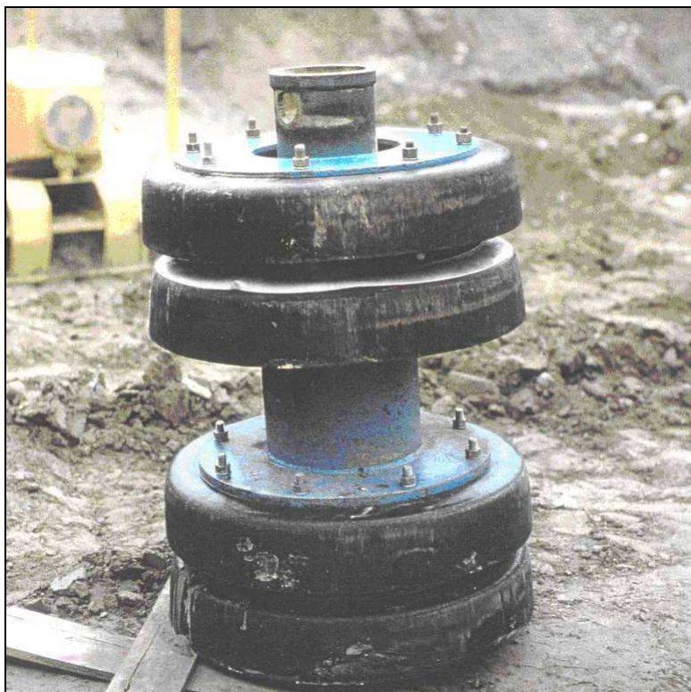
Fig. 8.1 - Pig convenzionale impiegato nelle operazioni di collaudo idraulico e di pulizia della condotta.
